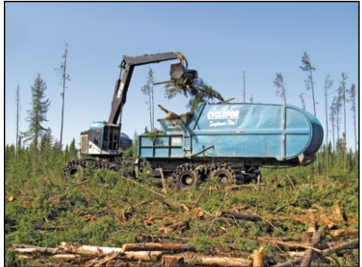
Récupérateur compacteur RC-03 (photo Luc Desrochers)
